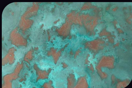
RAME/COPPER + L13 + PV + L3 + PE
